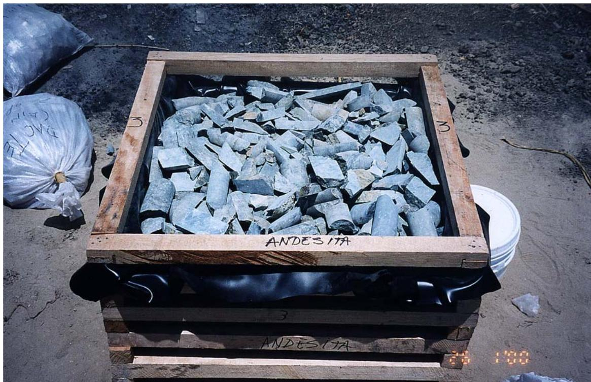
**Figura A4: Testigos de perforación sin triturar en la pila de lixiviación en campo**
