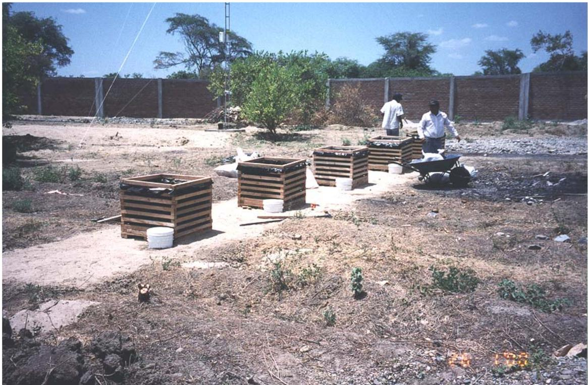
**Figura A2: Pilas de lixiviación en campo**
