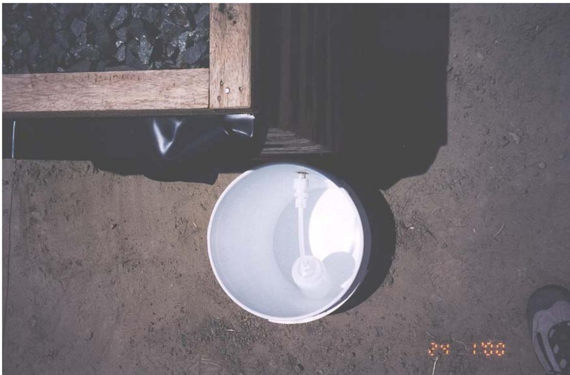
**Figura A3: Sistema de recolección de solución de lixiviación de la pila de lixiviación en campo**
